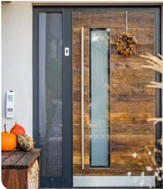
Aluminiumhaustür mit 72 mm Bautiefe, flügelüberdeckender Echtholzfüllung (Eiche rustikal geölt), sowie festverglastem, satiniertem Seitenteil, Edelstahlstangengriff, rahmenintegriertem Fingerscanner und Edelstahlsockelblech
